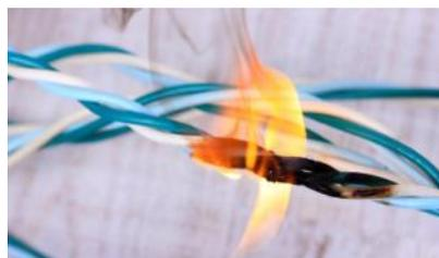
ния пожаров при эксплуатации электроустановок заключается в наличии сгораемой изоляции электрических сетей и источника зажигания (электрического тока). Большинство изоляционных материалов (хлопчатобумажная и шелковая ткань, резина,
